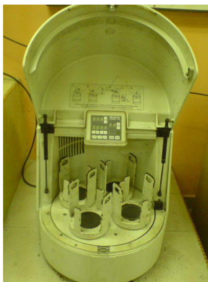
Gambar 1. Planetari bermerk Fitsch Pulverisette-5 dengan empat vial .
